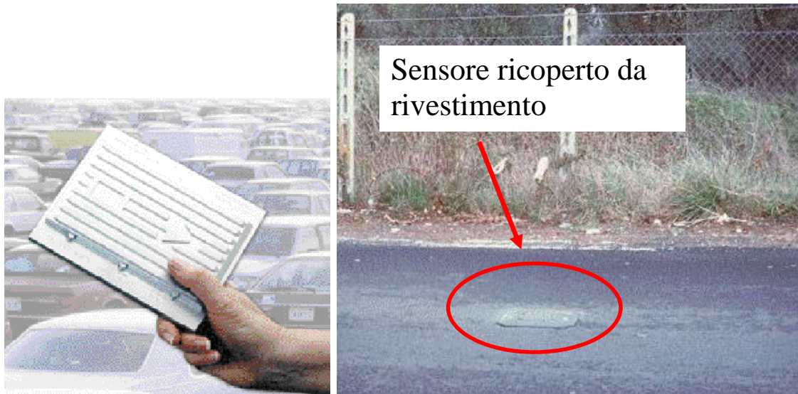
Figura 13 – Sensore magnetodinamico Nu-Metrics, da inserire al di sopra della pavimentazione, utilizzando per protezione un rivestimento rigido (a destra).
