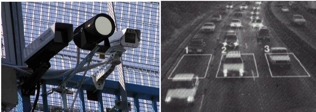
Figura 24 – Posizionamento di telecamera con illuminatore ad infrarossi (a sinistra) e principio di rilevamento video con elaborazione delle immagini mediante spire virtuali (a destra).
