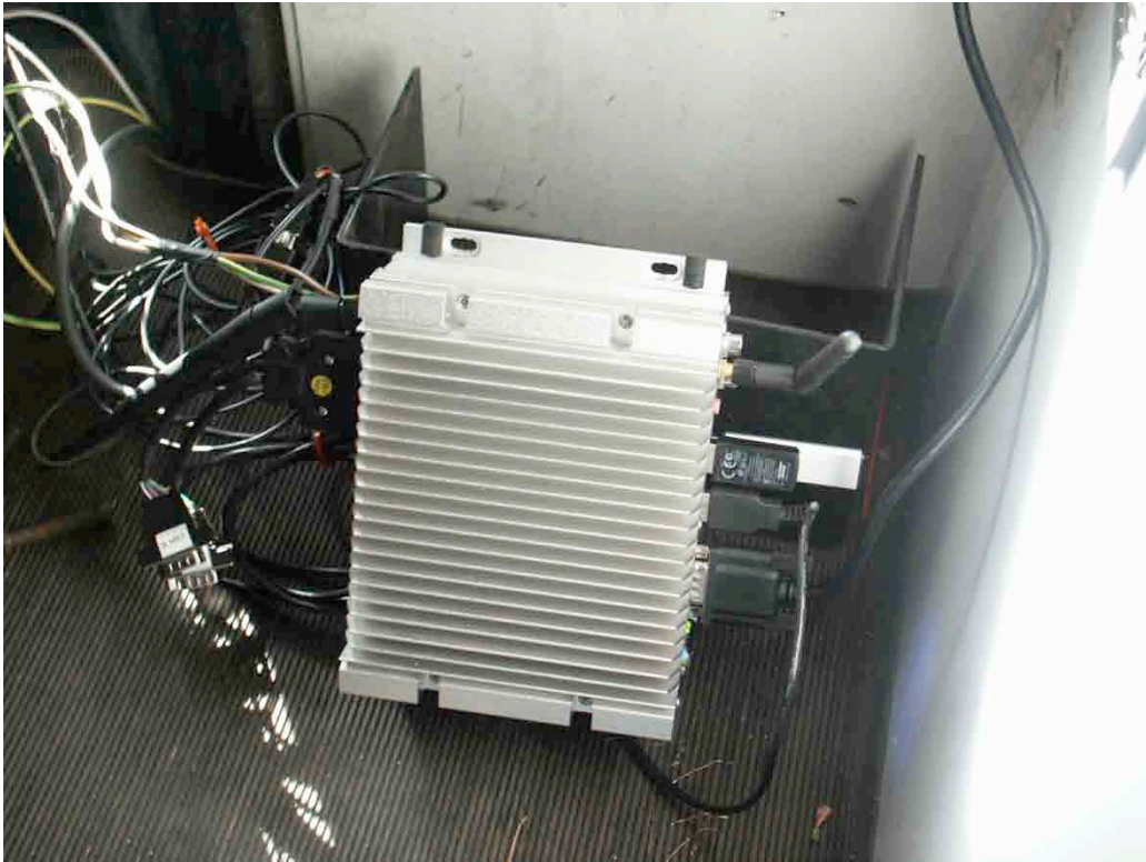
Figura 15: Posizionamento della OBU nel vano anteriore della navetta con le relative connessioni
