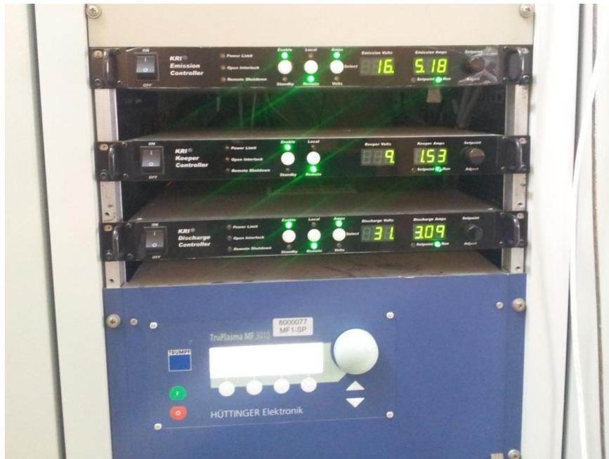
Figura 55. Alimentazione e controllo elettronico della sorgente KRI EH200/MHC1000: sistema d'innesco del neutralizzatore MHC1000 (Keeper Controller), alimentazione e controllo del neutralizzatore MHC1000 (Emission Controller) ed alimentazione e controllo del cannone ionico EH200 (Discharge Controller)
