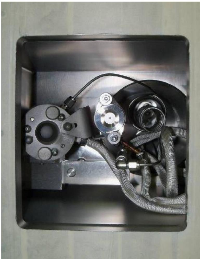
**Figura 53. Primo piano del cannone ionico KRI EH200 (sulla sinistra) e del neutralizzatore MHC1000 (sulla destra) installati sull'impianto di sputtering dell'ENEA**
