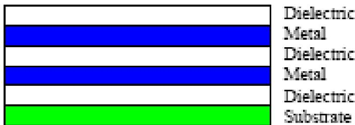
Figura 1. Schema di principio di un assorbitore solare multistrato
