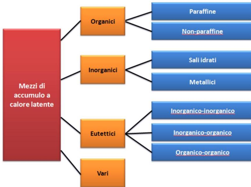
Figura 6- Classificazione dei mezzi di accumulo a calore latente
