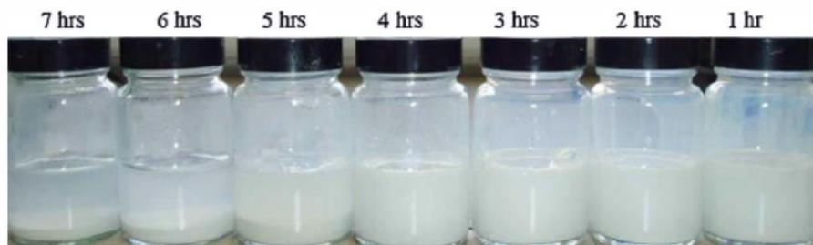
**Figura 17- Campioni di nanofluidi con Al2O3 (senza alcuno stabilizzatore: la stabilità cambia nel tempo (22))**
