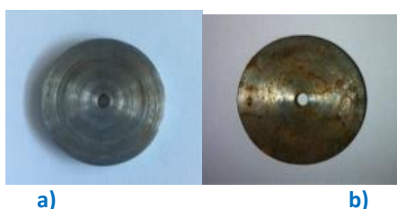
Figura 3- Provino di acciaio al carbonio prima del test di corrosione (a), dopo il test in \text{NaNO}_3\text{-KNO}_3 (b).
