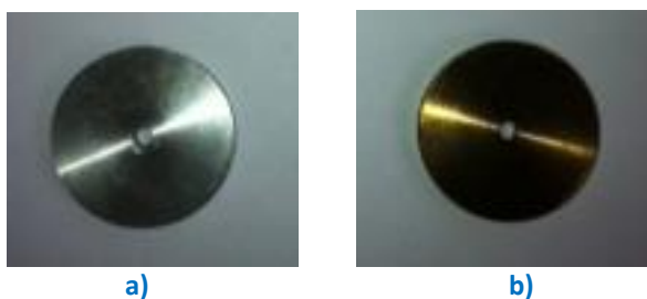
Figura 10- Provino di acciaio AISI 316 prima del test di corrosione (a), dopo il test in KNO 3 (b).
