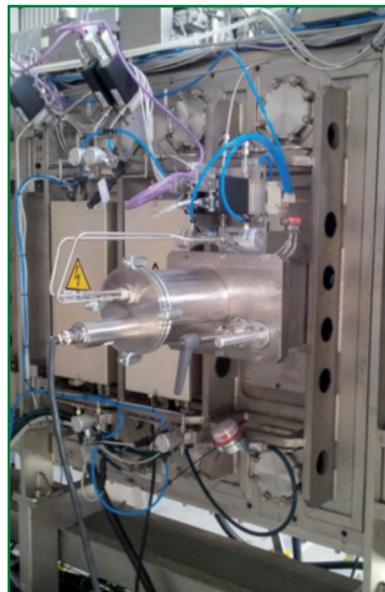
*Sezione di deposizione dell'impianto di sputtering ENEA: in primo piano l'interflangia per l'installazione della sorgente ionica KRI EH200/MHC1000*
