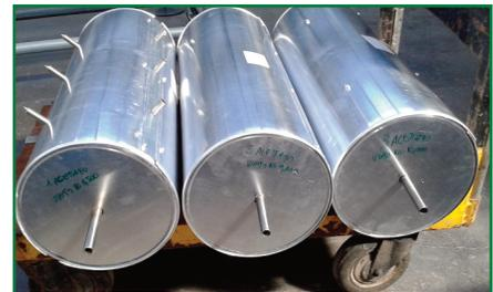
*Impianto per il test di elementi di accumulo a calore latente: vista dell'impianto ed alcuni componenti (termostato di circolazione, tubo alettato, elementi di accumulo)*
