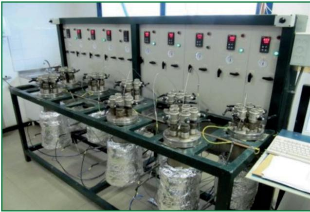
*Fornaci impiegate per effettuare i test di corrosione su acciai in bagno di sali nitrati a 550 °C*
