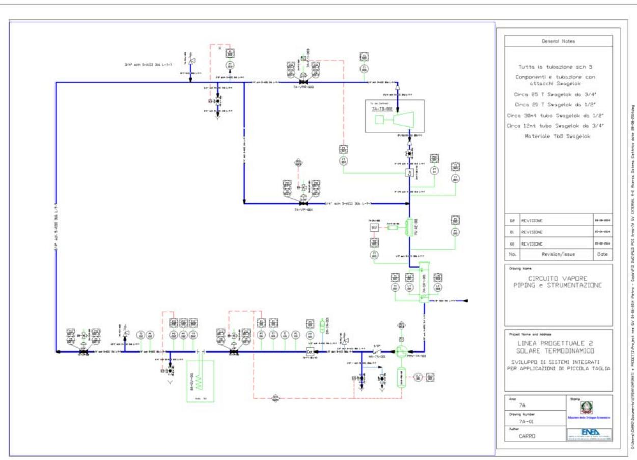
Figura 1. Circuito vapore dell'impianto con turbina da 1,5 kW – Schema d'impianto e strumentazione
