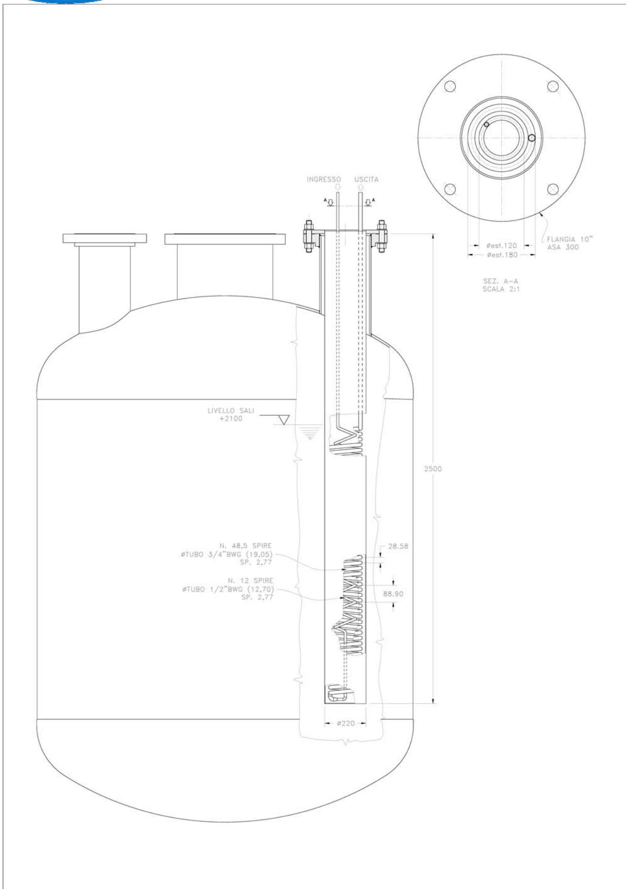
**Figura 2 – Vista d'insieme del serbatoio sali e del generatore di vapore “a pozzo”**
