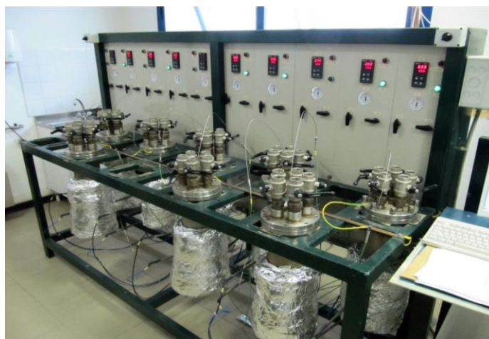
Figura 5- Fornaci impiegate per effettuare i tests di corrosione su gli acciai in bagno di sali nitrati a 550°C.
