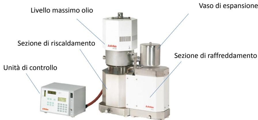
Figura 109: termostato di circolazione.
