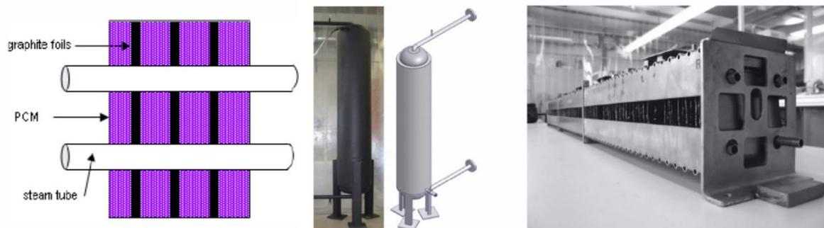
Figura 8 – Applicazione del concetto di LHTES sandwich: schema, modulo di prova, modulo per sistemi LHTES [6][8][10]
