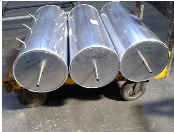
Figura 26- Terza di accumulatori a calore latente con coibentazione e lamierino esterno
