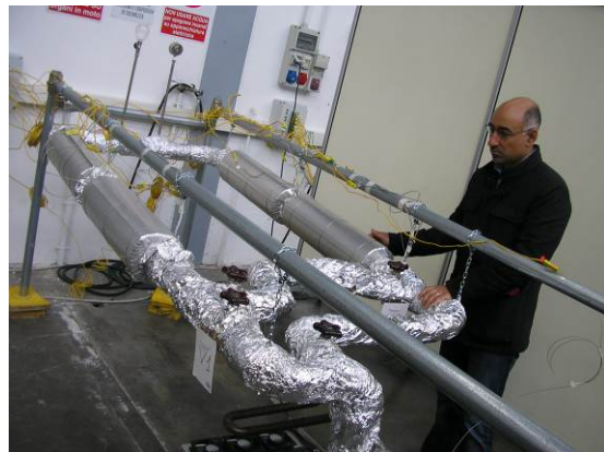
Figura 1- Circuito ad olio silconico SOLTECA, per il test degli accumulatori termici elementari, in fase di assemblaggio ed in esercizio.
