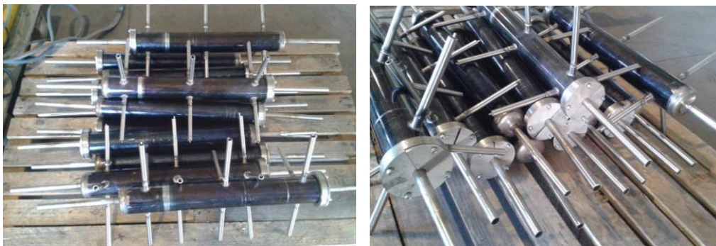
Figura 24- Accumulatori termici elementari prima della coibentazione
