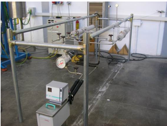
Figura 1- Circuito ad olio silconico SOLTECA, per il test degli accumulatori termici elementari, in fase di assemblaggio ed in esercizio.
