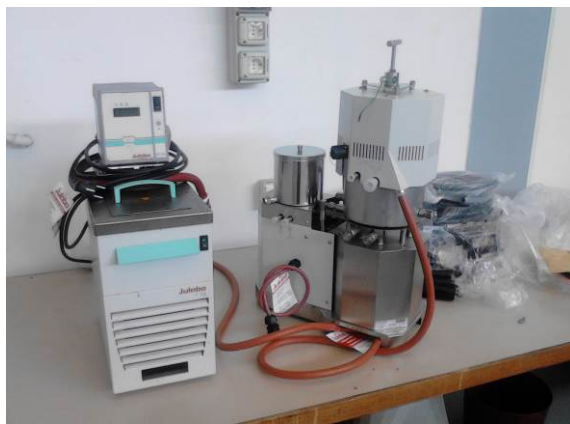
Figura 28- Gruppi di riscaldamento/raffreddamento e pompaggio dell'olio diatermico (Julabo)
