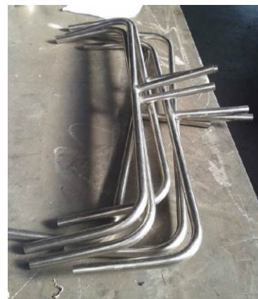
Figura 29- Piping di connessione tra accumulatori con derivazione a T per valvole di sfiato e svuotamento
