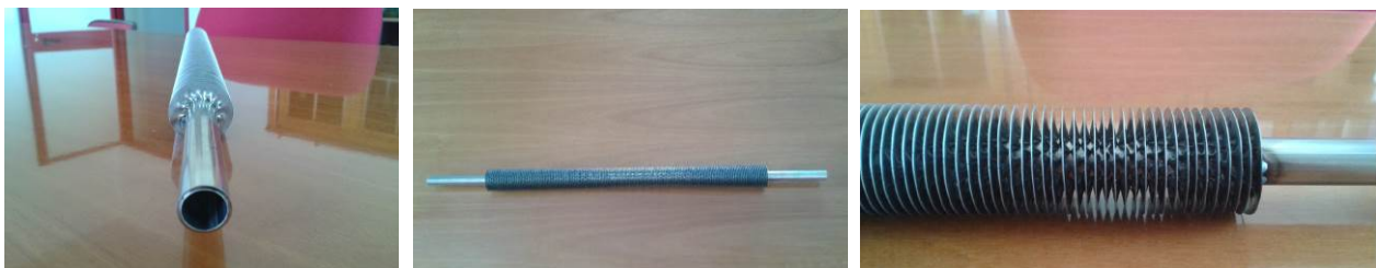
Figura 25- Tubo alettato utilizzato per la realizzazione degli elementi base di accumulo a calore latente
