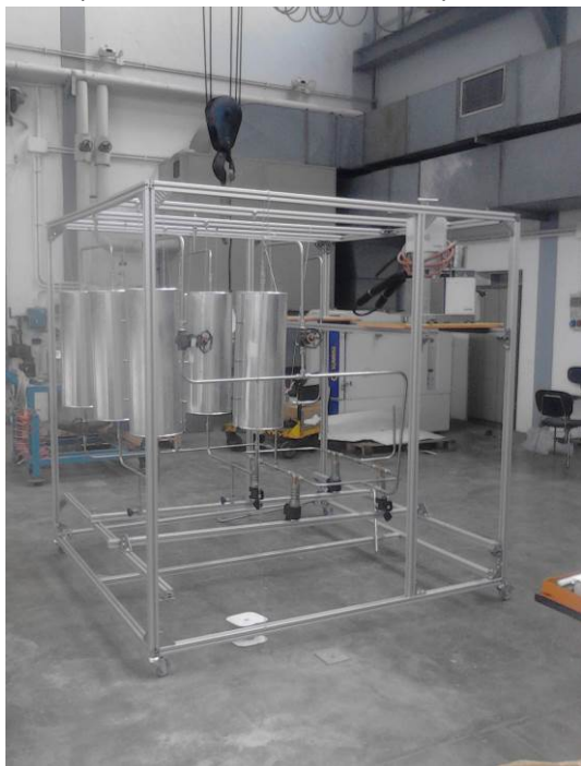
Montaggio degli accumulatori e delle tubazioni
