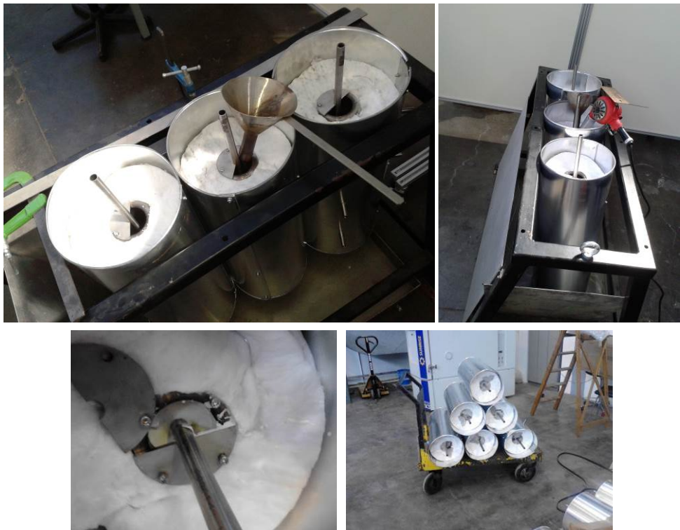
Figura 30- Fasi di riempimento di due terne di accumulatori elementari coibentati contenenti PCM
