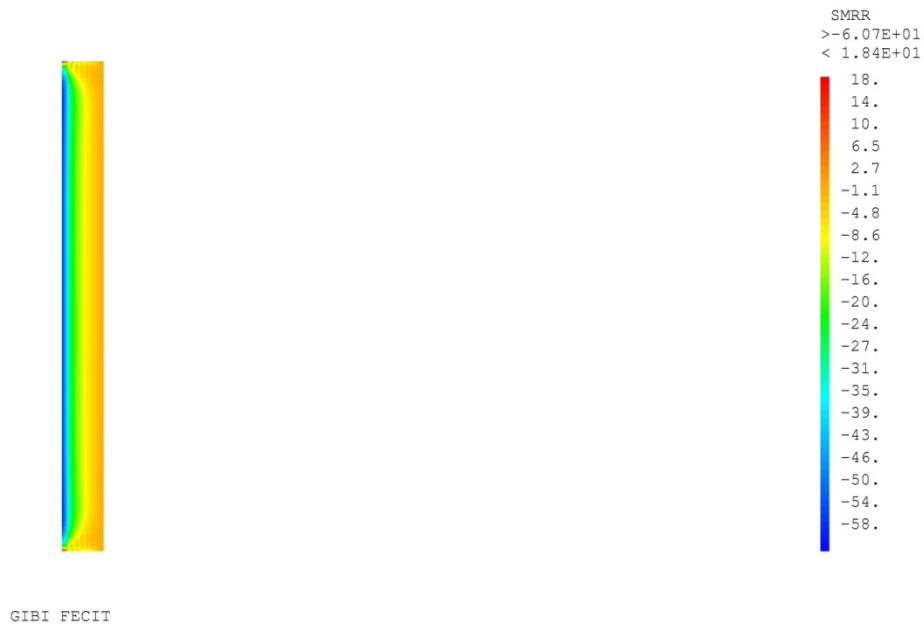
Figura 21 Isovalori della tensione radiale in MPa nel tubo ed elemento d'accumulo a fine riscaldamento.
