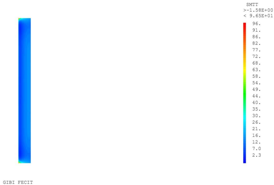
Figura 22 Isovalori della tensione tangenziale in MPa nel tubo ed elemento d'accumulo a fine riscaldamento.
