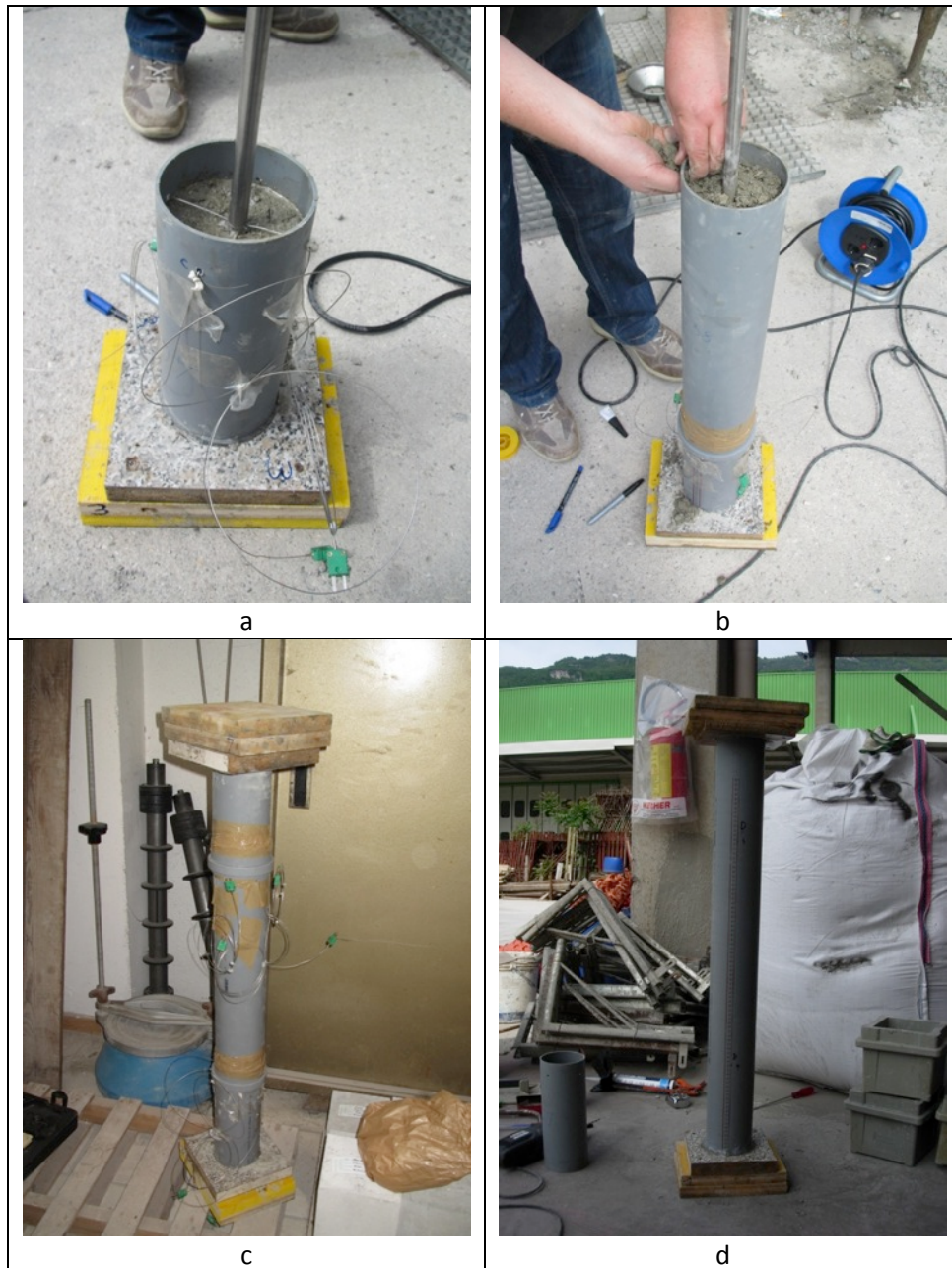
Figura 4 – Confezionamento dell'Elemento 1 (a,b,c) e dell'Elemento 4 (d).
