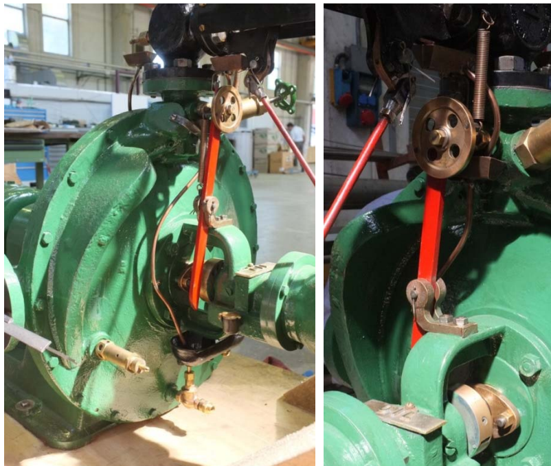
Figura 13: meccanismo di comando dell'overspeed trip valve a massa centrifuga con riarmo manuale, sinistra; particolare del volantino valvola con molla elicoidale, destra
