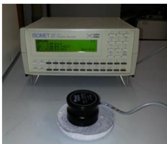
Figura 10 - Conduttimetro utilizzato e provino.
