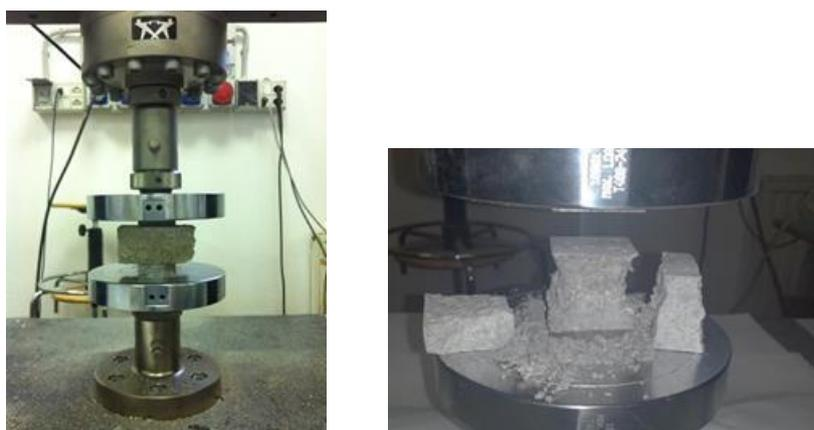
**Figura 29- Provino sottoposto a compressione.**
