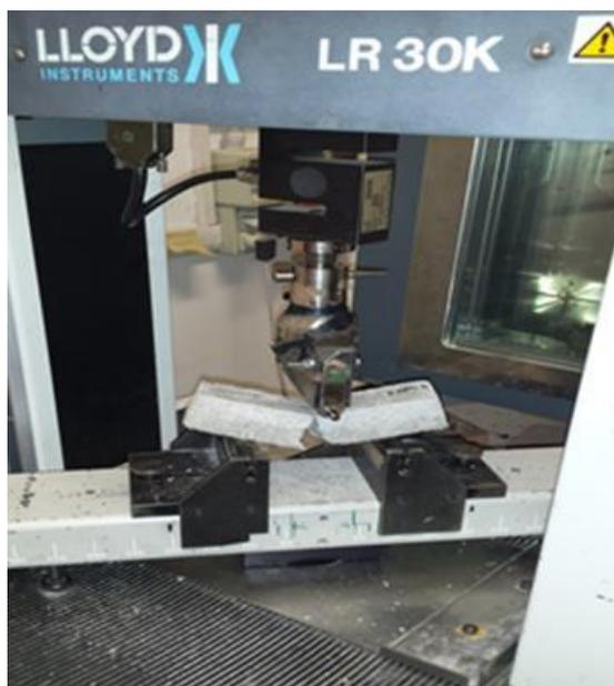
**Figura 26- Provino sottoposto a flessione.**
