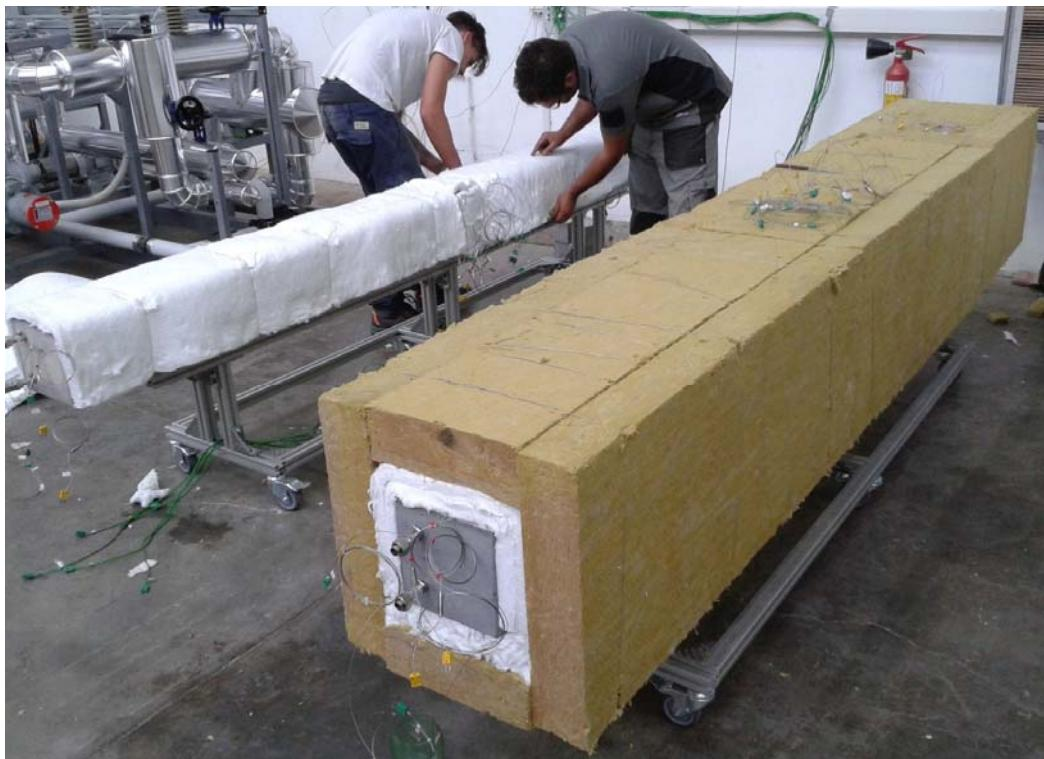
Figura 17: particolare del sistema di accumulo, nel quale si vedono gli strati di coibentazione.
