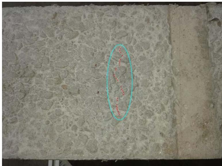
Figura 50: Modulo UNITN-CESTARO, fessurazioni a circa 70 cm dopo il ciclo di degassaggio.
