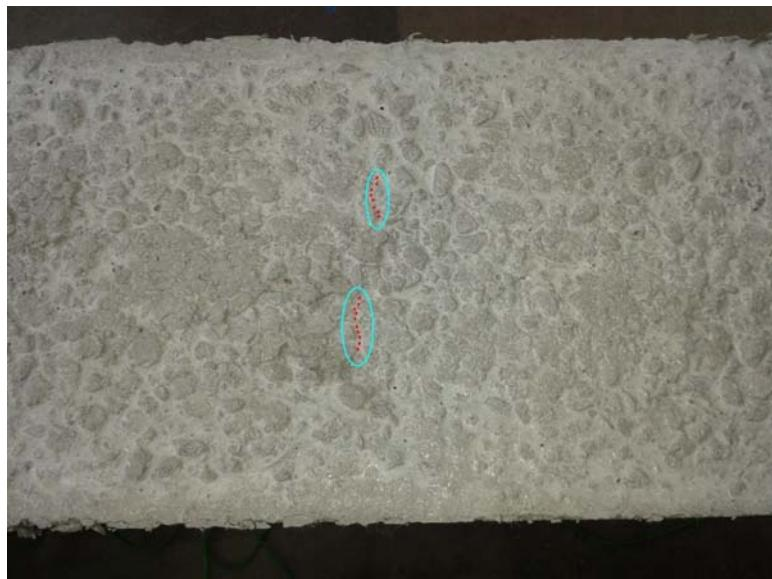
Figura 51: Modulo UNITN-CESTARO, fessurazioni a circa 1993 cm dopo il ciclo di degassaggio.
