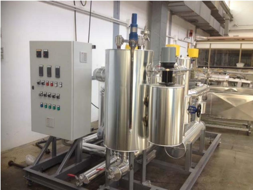
Figura 7: particolare dell'impianto Solteca3, nel quale è possibile vedere il quadro di comando in locale.
