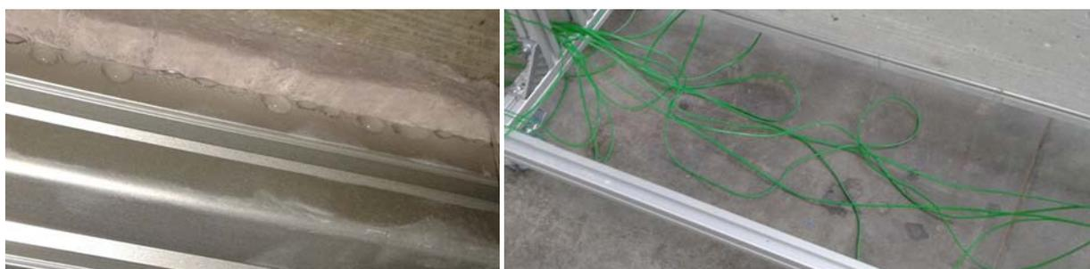
Figura 40: Condensazione e gocciolamento del modulo UNITN-CESTARO.
