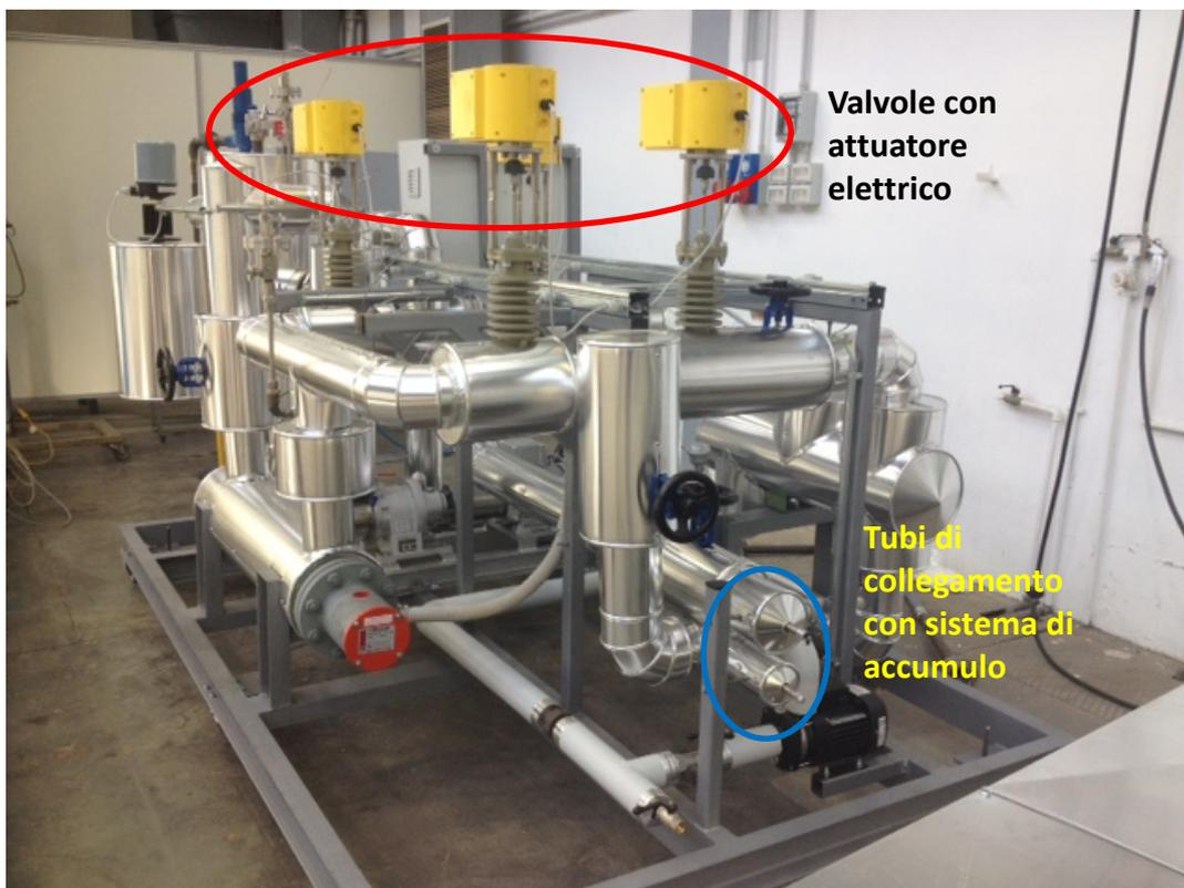
**Figura 9: particolare dell'impianto Solteca3, nel quale sono visibili le valvole con attuatore elettrico e i tubi di collegamento con il sistema di accumulo.**
