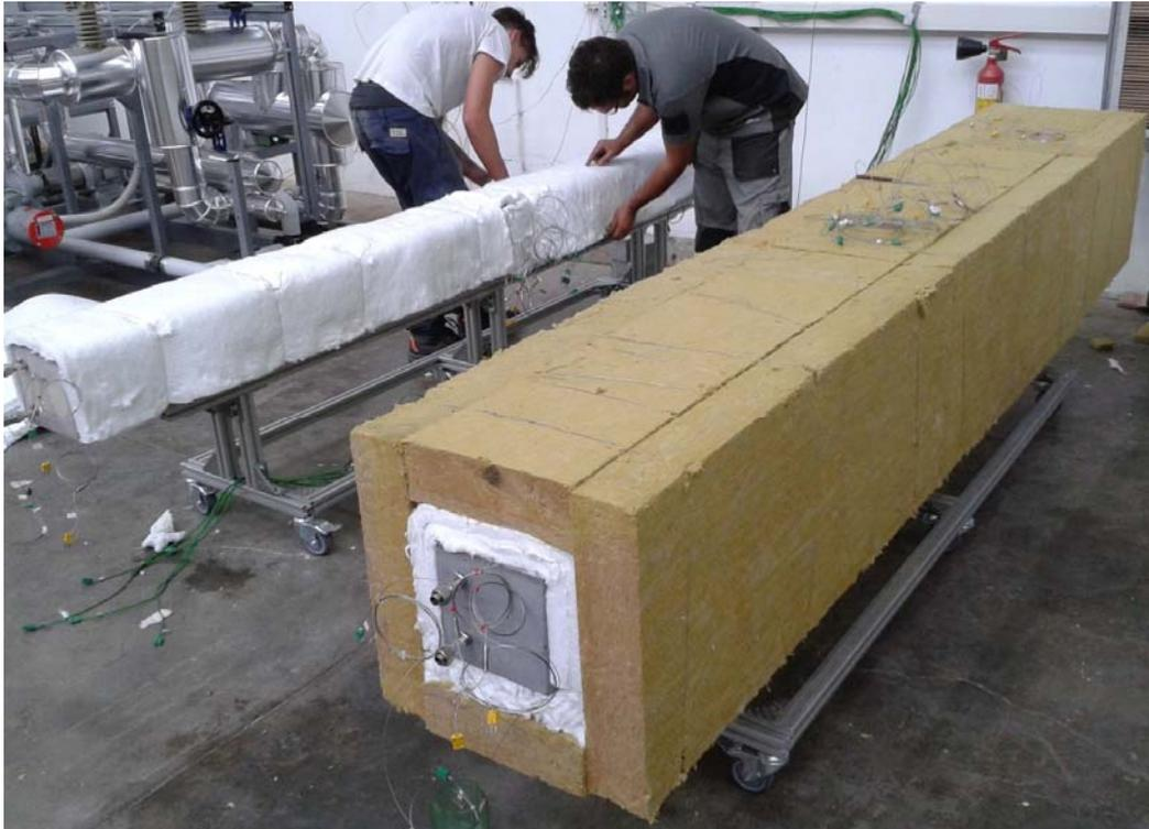
Figura 17: particolare del sistema di accumulo, nel quale si vedono gli strati di coibentazione.
