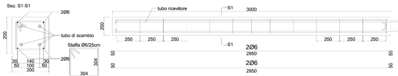
Figura 3 – Disposizione e dimensioni dell'armatura.
