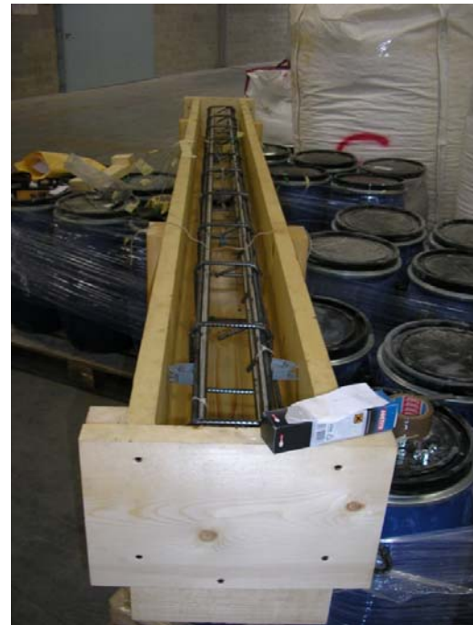
Fig. 12 Fasi del posizionamento finale dei ferri di rinforzo, del tubo di scambio e delle termocoppie da affogare nel getto.
