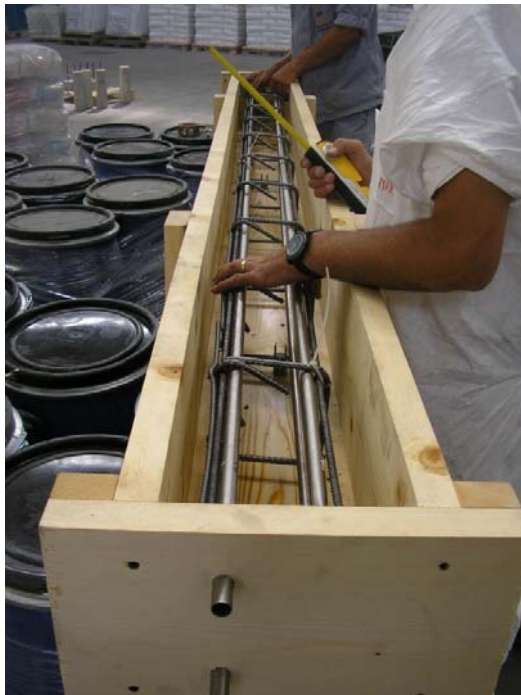
Fig. 12 Fasi del posizionamento finale dei ferri di rinforzo, del tubo di scambio e delle termocoppie da affogare nel getto.
