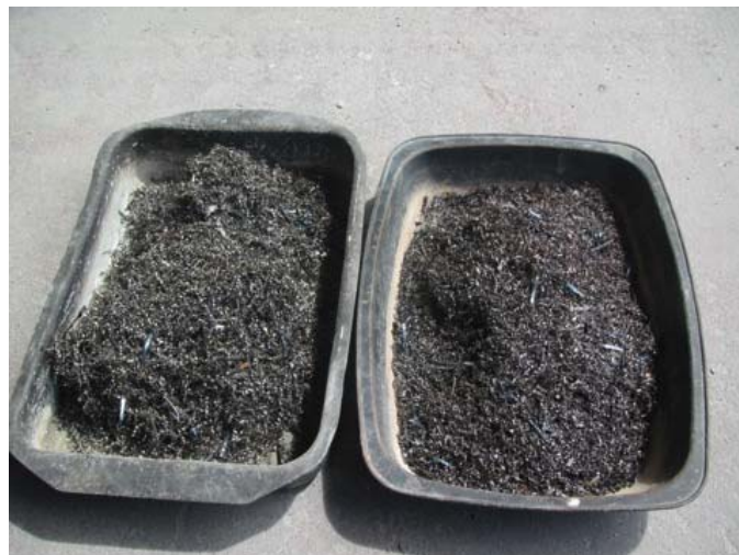
Fig. 9 Trucioli di acciaio impiegati nel mix design (UNITN-Cestaro) [1].
