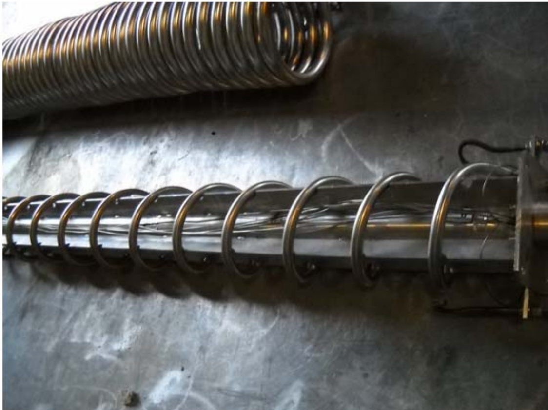
Figura 2-2 Particolare dei 2 fasci tubieri (interno ed esterno) del generatore di vapore a pozzo
