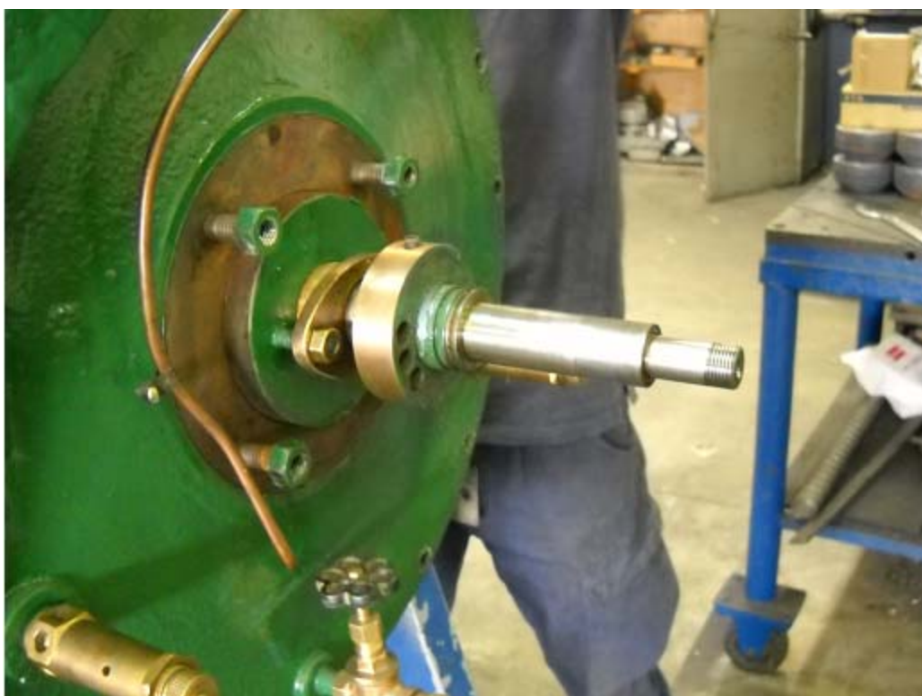
Figura 2-4 Particolare del guscio della girante prima dello smontaggio
