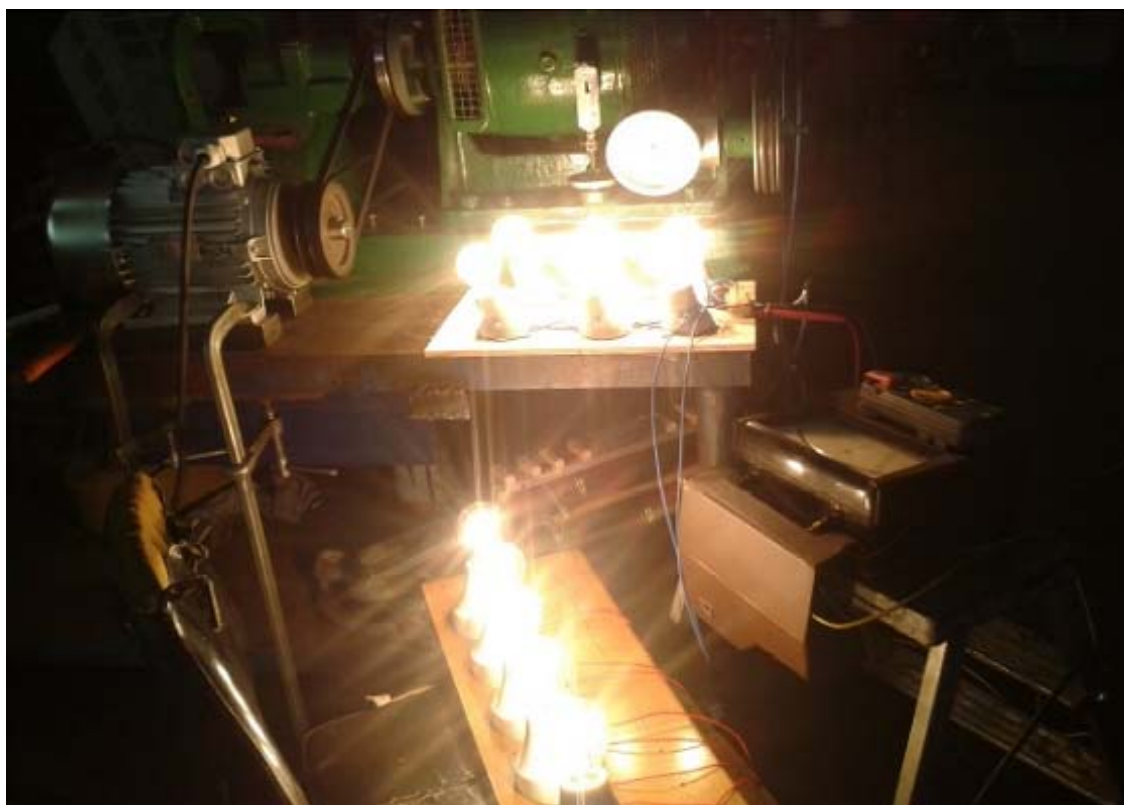
Figura 2-7 Dissipazione dell'energia elettrica generata
