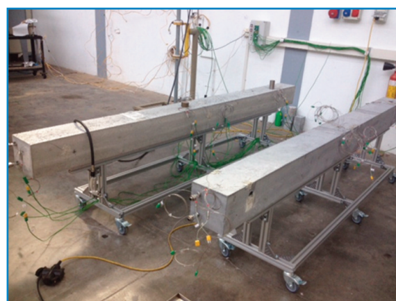
Moduli di accumulo termico in calcestruzzo
