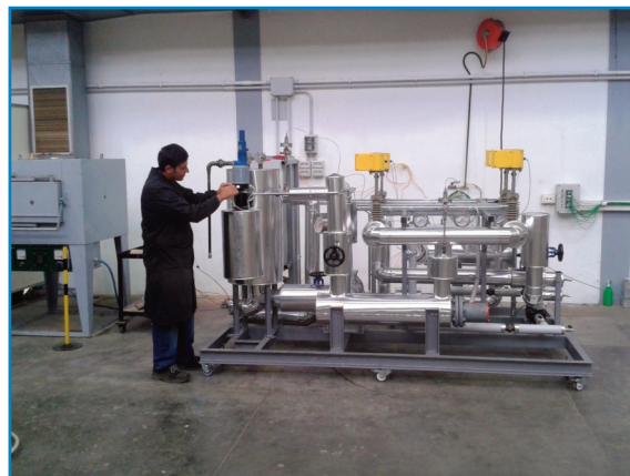
Impianto per il test di elementi di accumulo in calcestruzzo
