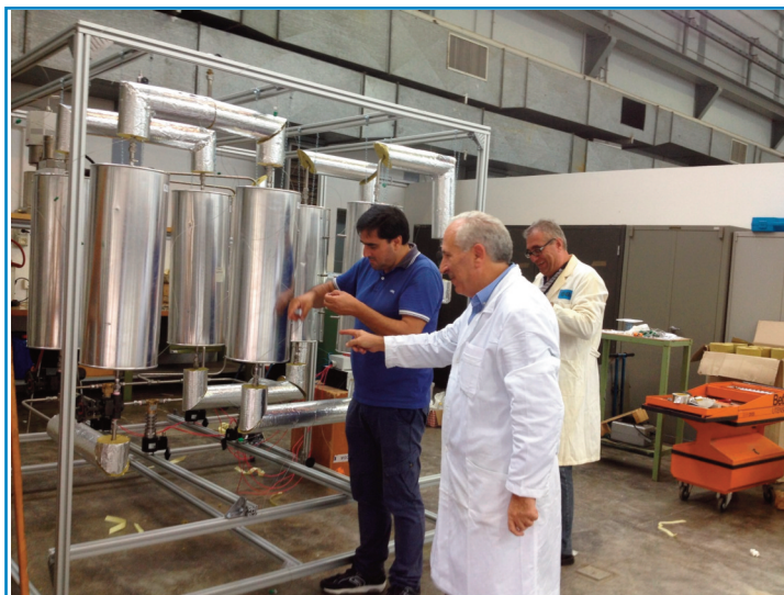
Impianto ATES per il test di elementi di accumulo a calore latente
