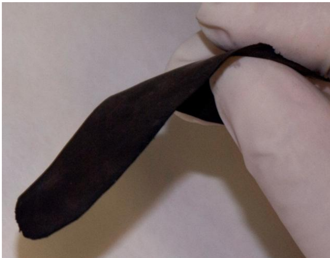
Figura 9. Nastro catodico preparato secondo le modalità descritte in 3.2.2.1.
