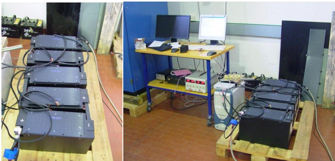
Fig. 1 Pacco batterie EIG da 40 Ah 86 V
