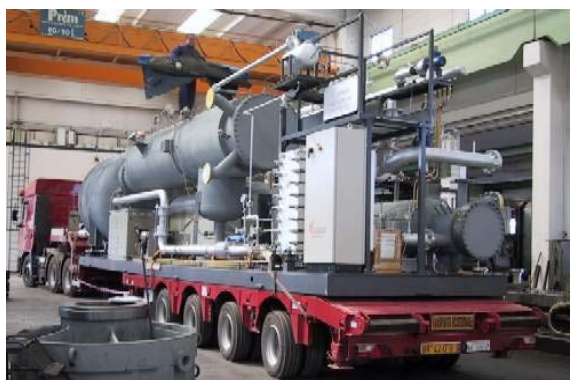
Fig. 3.5.7 – Modulo ORC Turboden T600-CHP pronta per il trasporto
