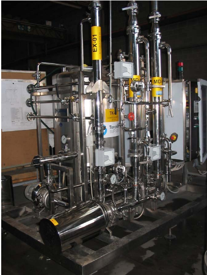
Figura 15. Impianto pilota di microfiltrazione ceramico per la bonifica microbica del siero di latte.
