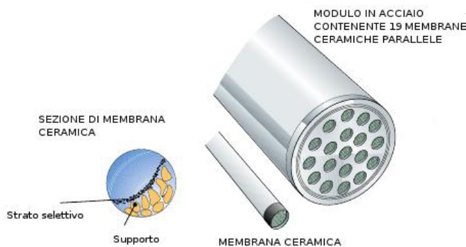
Figura 7. Membrane tubolari ceramiche: moduli, membrana e strato selettivo
