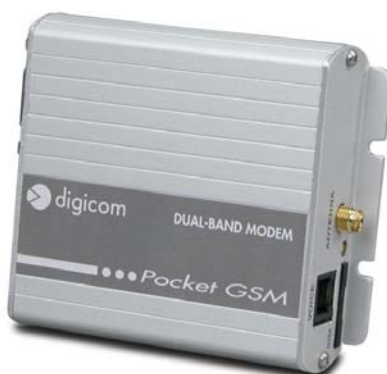
Fig. 25 - Modem GSM con interfaccia seriale (DIGICOM 8D0114 GSM Pocket)
