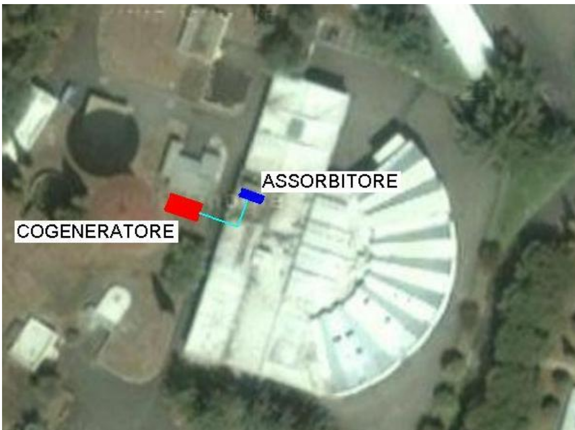
Figura 11 : Posizionamento dell'impianto di trigenerazione presso l'edificio F13
