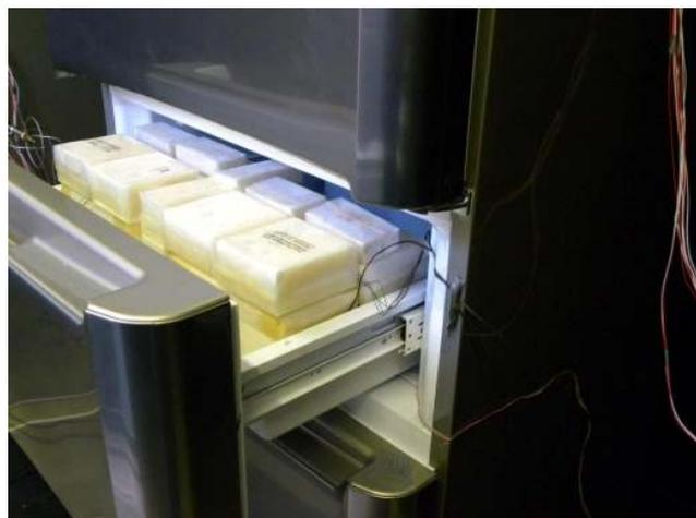
**Figura 6: Termoresistenze all'interno dell'elettrodomestico del freddo**
