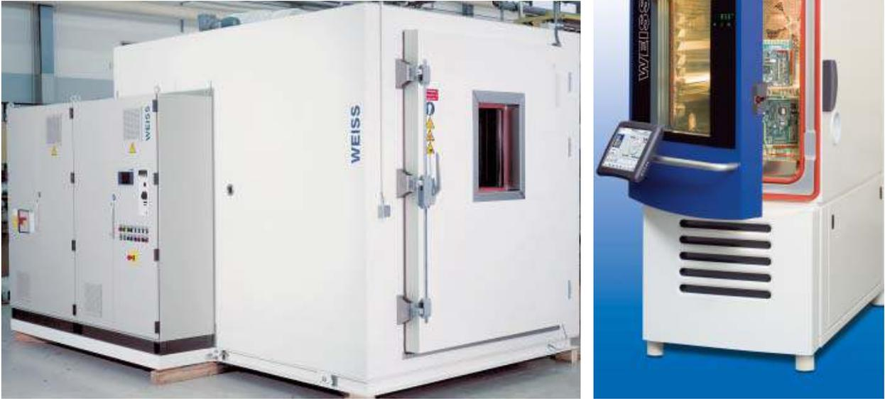
**Figura 3: A sinistra: esempio di camera climatica *walk-in*. A destra: la camera climatica a dimensioni ridotte.**
