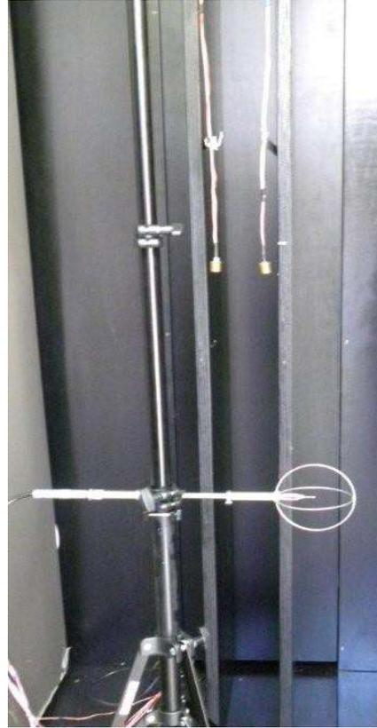
**Figura 5: Misura della velocità dell'aria (anemometro) e temperatura nella camera climatica**
