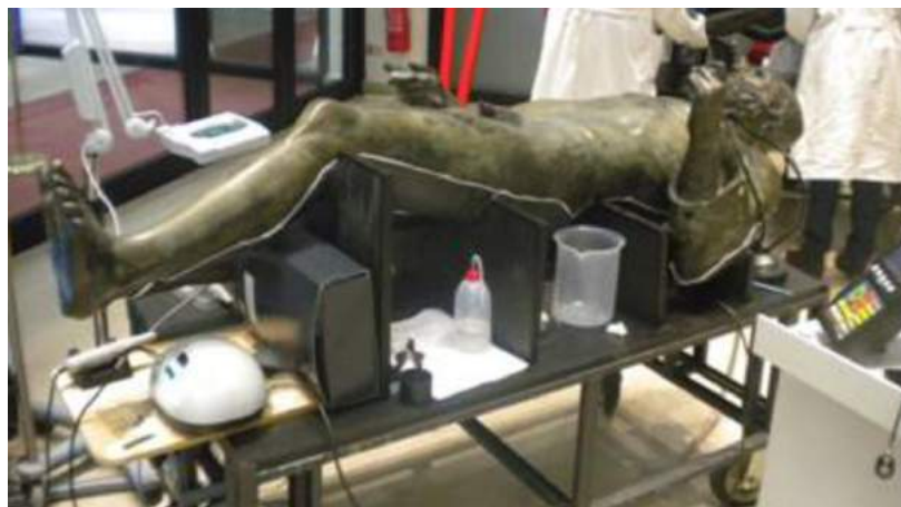
Bronzi di Riace: Indagini Ultrasoniche con tecnica Pulse Echo per mappatura spessori
