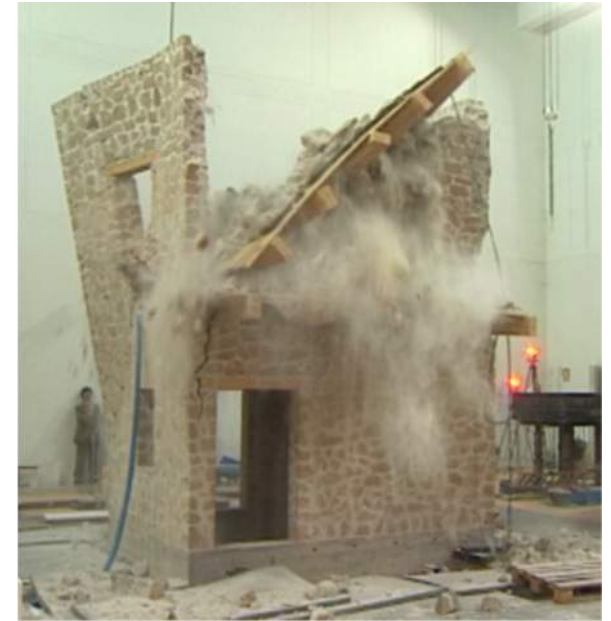
Cinematismi di collasso di un edificio in muratura tipico dell'edilizia storica italiana
