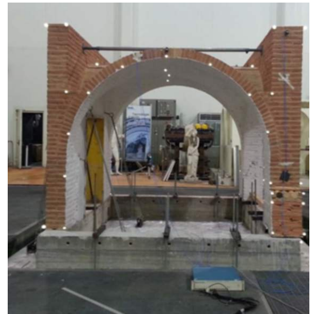
Modello in scala 1:6 del macro elemento "Volta a Crociera" della Moschea di Algeri
