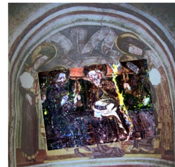
Evidenza mediante LIF imaging di una depigmentazione sul modello 3D di un affresco
