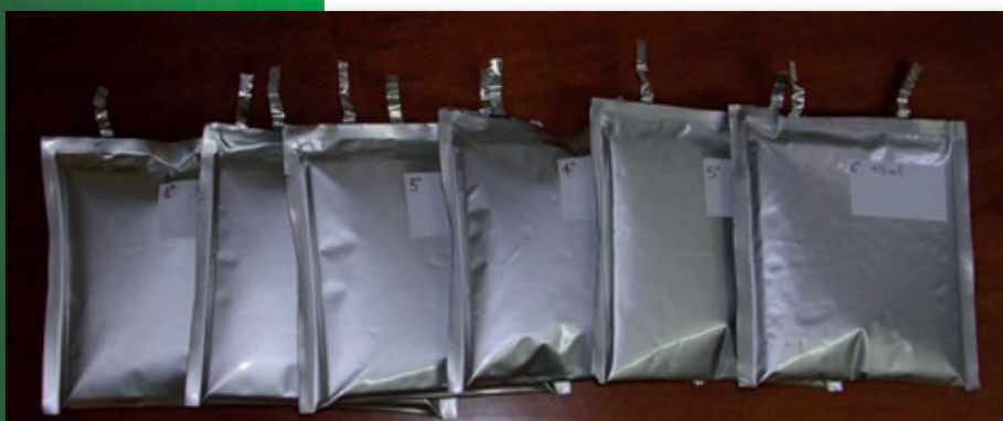
Batterie soft pouch deformate
