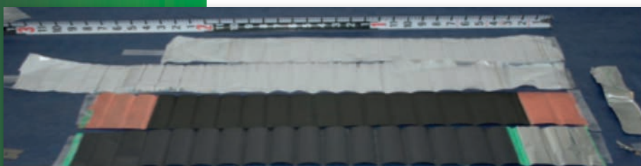
Struttura interna di una batteria soft pouch
