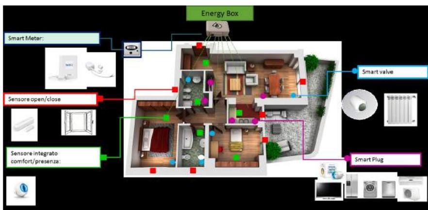
L'unità centrale, o Energy Box, una piattaforma informatica open source in collegamento wi-fi realizzata in collaborazione con l'azienda Apio, raccoglie i dati sulla situazione ambientale, li rielabora e fornisce dei feedback all'utente che può verificare i suoi consumi tracciando le proprie performances e confrontandosi con altri utenti per incentivare un uso più efficiente dell'energia.
