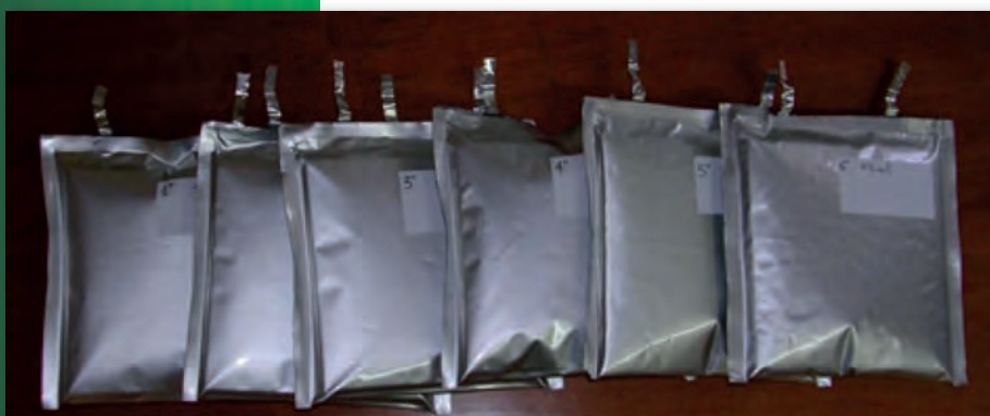
Batterie soft pouch deformate
