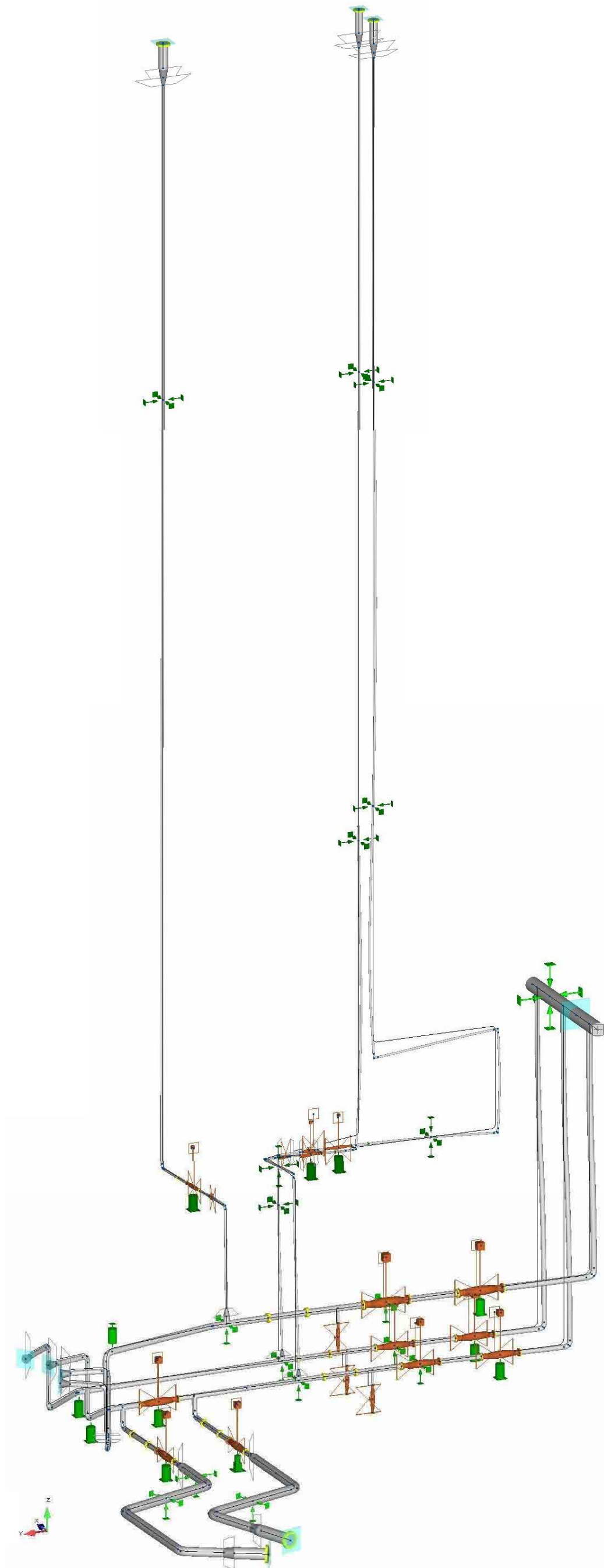
Figura A1-76: FL caso 2: Visualizzazione degli spostamenti del circuito sotto l'effetto combinato del peso del sistema e del suo contenuto
