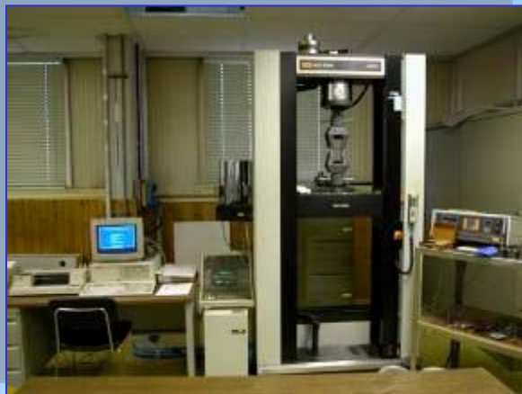
Macchina universale Instron Mod. 4507, cella da 150 kN
