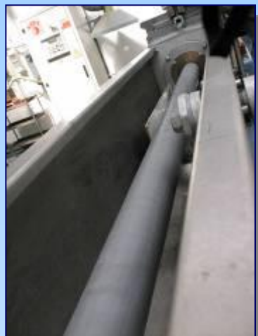
Tubo in SiC durante la fase di estrusione
