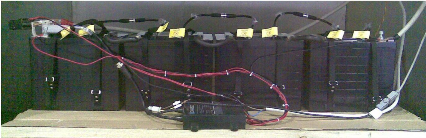
Sistema di accumulo 200 Ah/48 V adatto a diverse esigenze di trazione elettrica in fase di test
