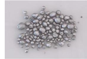
E' stato sviluppato un processo per la realizzazione di sfere cave di alluminio mediante tecnologia basata sulla granulazione di miscele di polveri di alluminio e polveri organiche, e legante organico, successivo dewaxing e sinterizzazione a 650 ;
