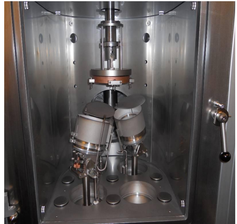
Impianto di deposizione per sputtering
