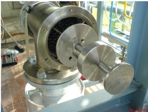
Modello di bruciatore TVC per analisi sperimentali parametriche
