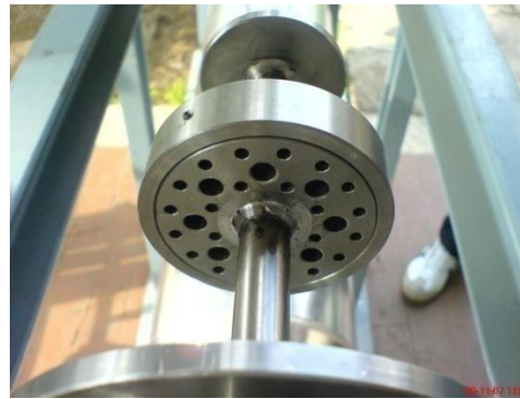
Modello di bruciatore TVC per analisi sperimentali parametriche
