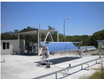
Foto del concentratore parabolico lineare della ditta SOLTIGUA in fase di test
