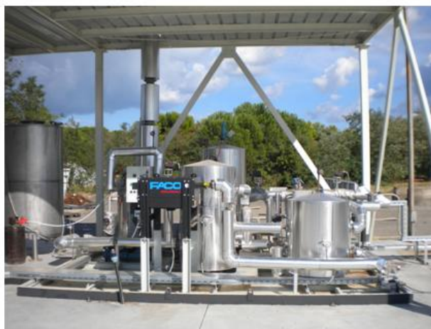
Vista laterale del circuito di prova ad olio diatermico
