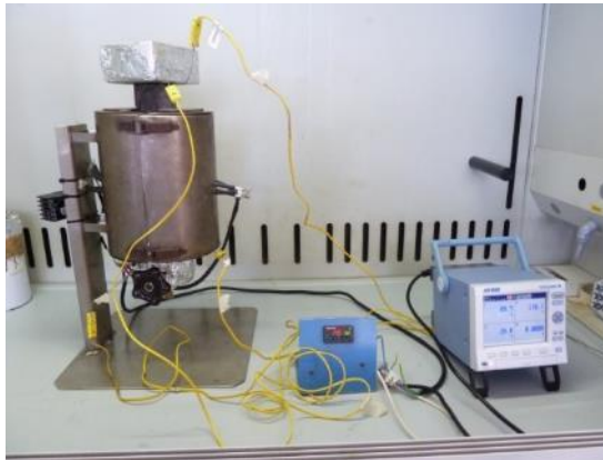
Sistema sperimentale per la misura della stabilità termica
