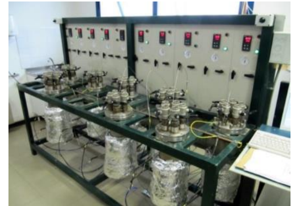
Impianto per prove di corrosione statiche su acciai in una miscela ternaria dei nitrati fusi a 550 °C
