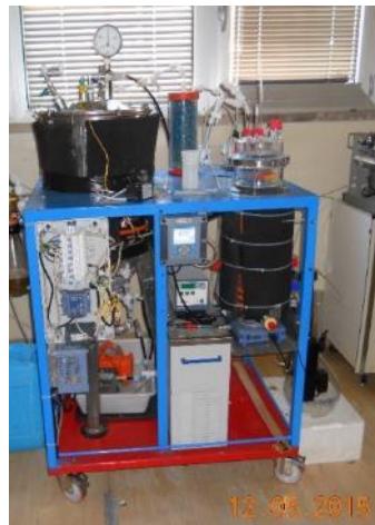
Impianto di digestione anaerobica a doppio stadio
