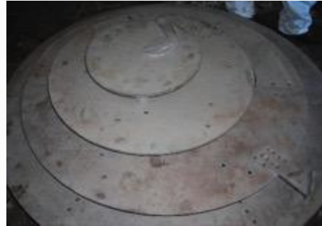
Particolare griglia di scarico ceneri
