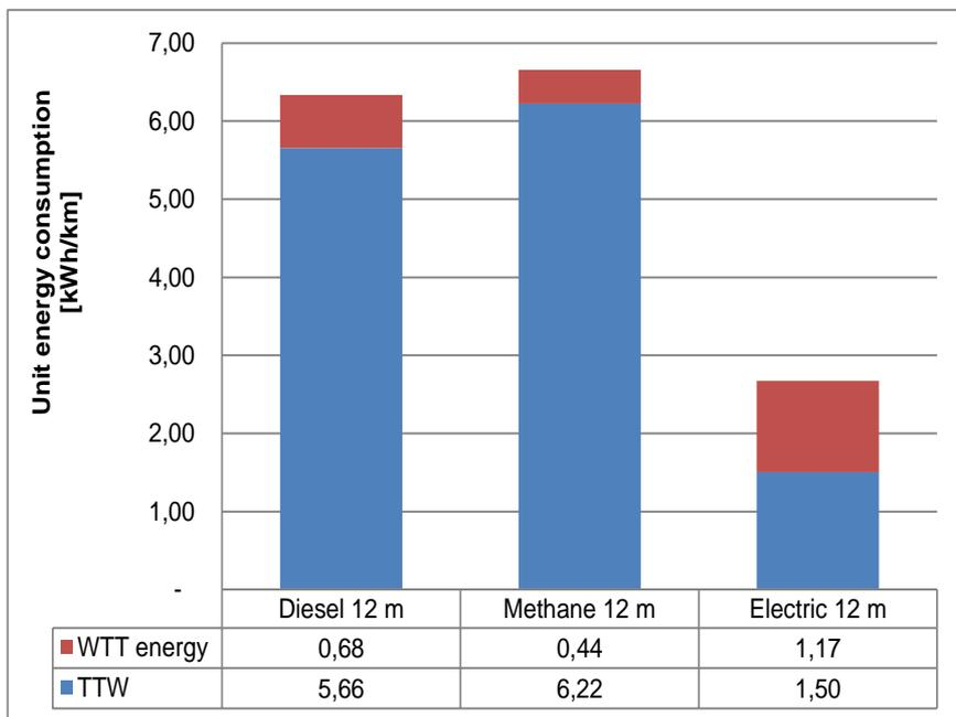
Il consumo nominale alle ruote di un bus elettrico è circa un quarto di un diesel, sull'intero ciclo di vita della fonte energetica il rapporto fra i due consumi si attesta intorno al 50%. Nel caso del motore a combustione interna l'energia consumata è tutta di origine fossile mentre nel caso dell'elettrico incide una quota parte di energia rinnovabile che attualmente, per il parco elettrico italiano, è pari al 28% circa.
