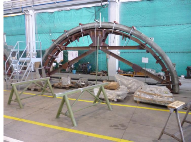
3° gamba curva in fase di assemblaggio
