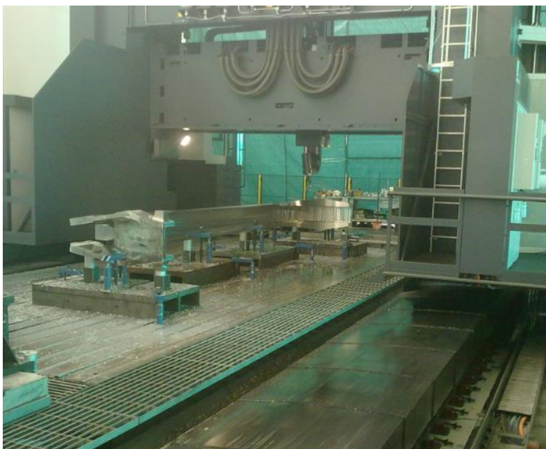
Lavorazione di finitura della gamba dritta
