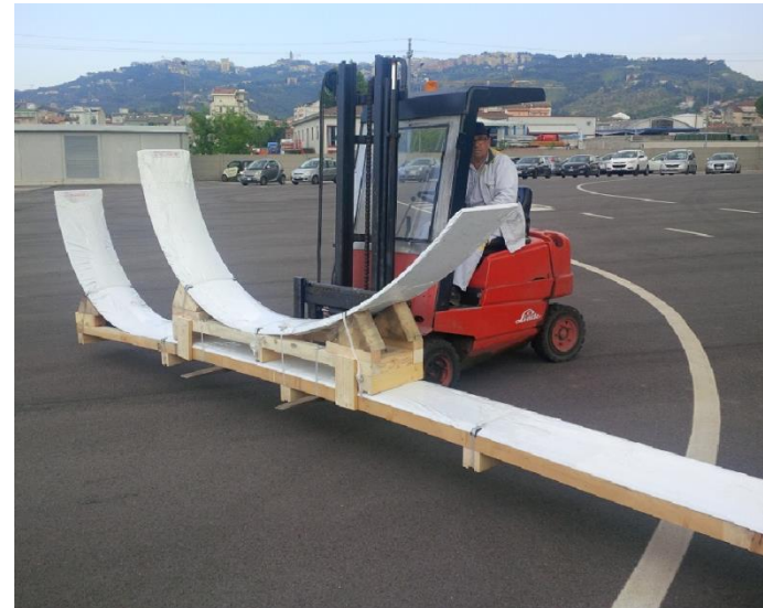
Movimentazione e carico delle cover
