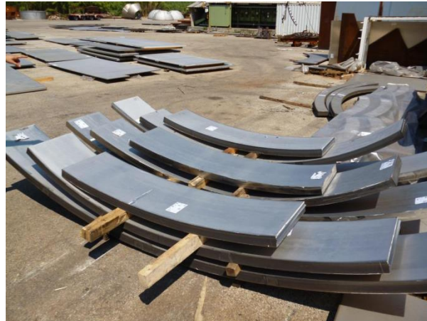
Lamiere calandrate per gambe curve
