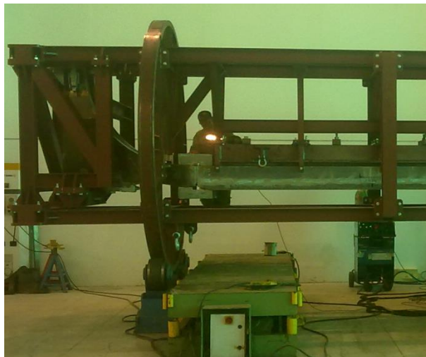
Saldatura gomiti della gamba dritta (ASG-C)
