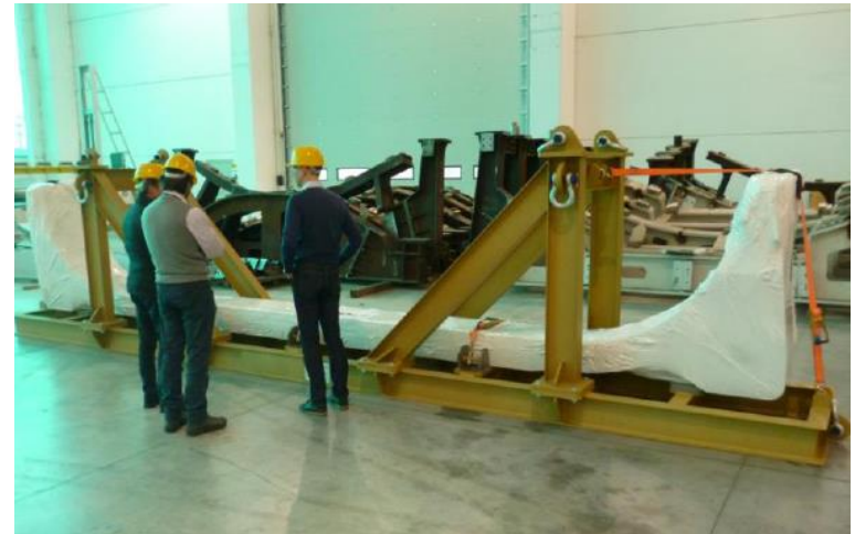
Telaio di trasporto della gamba dritta
