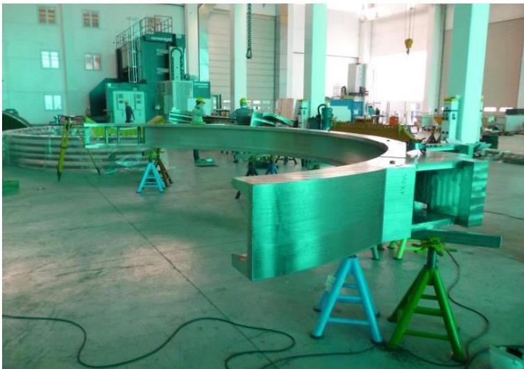
Controllo dimensionale con laser tracker della gamba curva ASG-A
