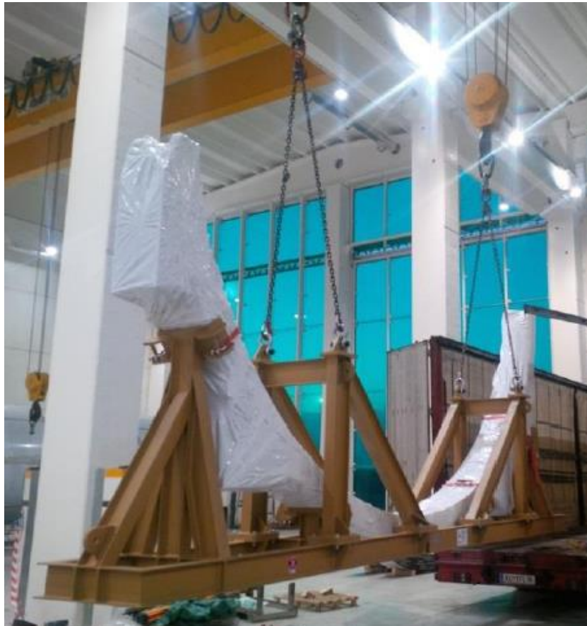
Telaio di trasporto della gamba curva, movimentazione e carico
