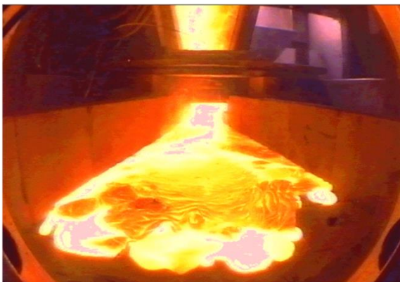
Test sperimentali di fusione del nocciolo (corium)
