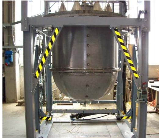
E' stata eseguita una prima campagna sperimentale (6 prove di miscelamento termico) sulla sezione di prova in scala 1:5 che riproduce il downcomer e lower plenum di uno SMR, con lo scopo di validare i codici CDF usati per le analisi di sicurezza di tali reattori (SMRs).
