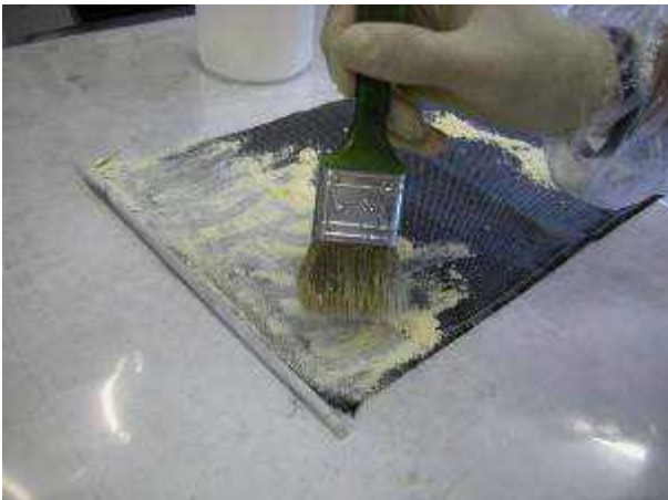
Impregnazione per avvolgimento tubo
