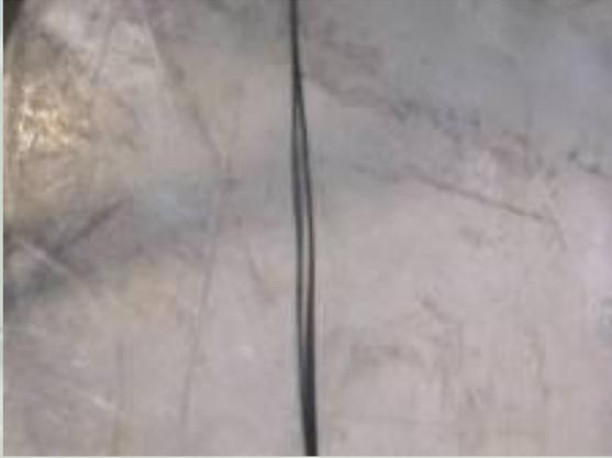
Gli yarns sono risultati troppo delicati con tendenza alla rottura con l'applicazione di una minima forza.
