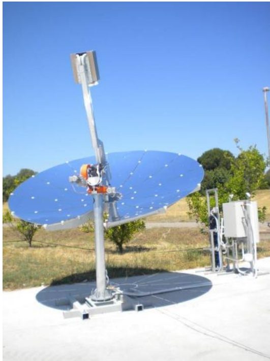
Foto del set-up sperimentale del sistema Dish/Stirling
