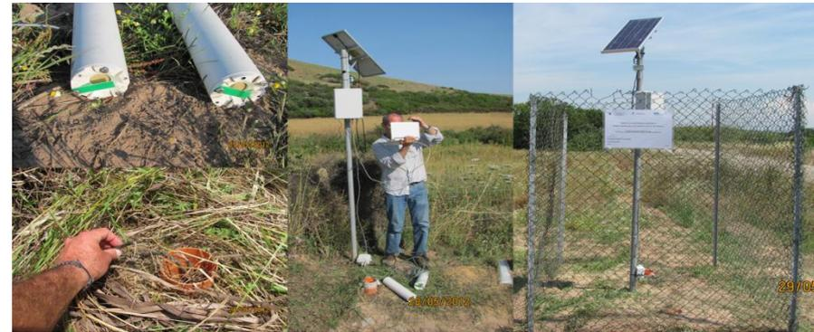
**Figura 1.** Intervento di manutenzione (maggio 2012) effettuato per ripristinare la completa funzionalità dei sistemi e per verificare la corretta calibrazione delle sonde di misura.
